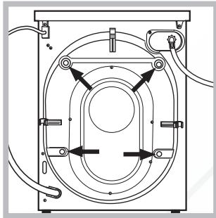
3. Удалите четыре транспортировочных винта и резиновые пробки с прокладками, расположенные в задней части стиральной машины (см. рис.).
